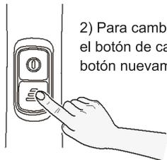
2) Para cambiar la velocidad a BAJA, presione el botón de cambio de velocidad. Presione este botón nuevamente para volver a la velocidad ALTA.
