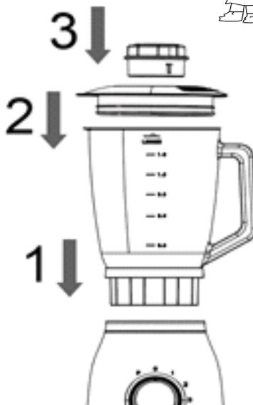
1.- Para fijar el jarro, insértelo en la base del motor ubicada en el cuerpo de la licuadora, presionando levemente hacia abajo tal como indica la figura 1. Si el jarro no es colocado correctamente en la base de motor, el aparato no funcionará.
