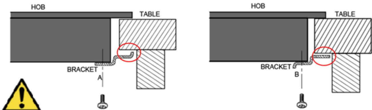
Bajo ninguna circunstancia, los ganchos de anclaje debe tocar partes interiores del corte en la cubierta (como se ve en el dibujo) .
